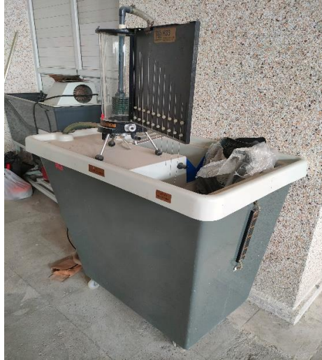
Şekil 1. Orifis ve jet yörüngesi belirleme deneyi
